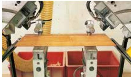
Tronçonneuse perceuse tourillonneuse CNC
