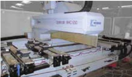
Centre d'usinage 4 axes CNC
